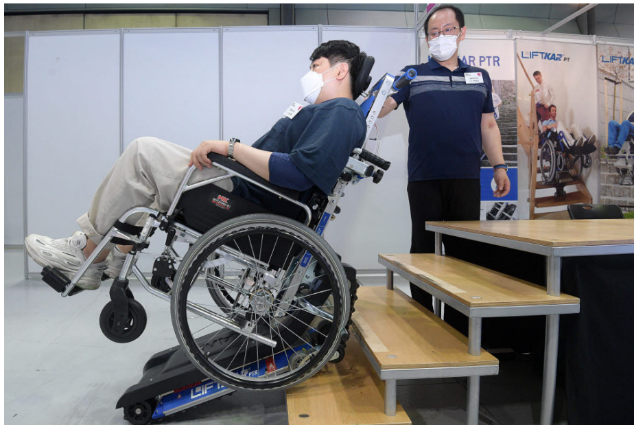
<강남캐스터넷 부스에서 관계자가 환자의 휠체어를 계단에서도 운반할 수 있는 무한계도형 전동 리프트카를 시연하고 있다.>
